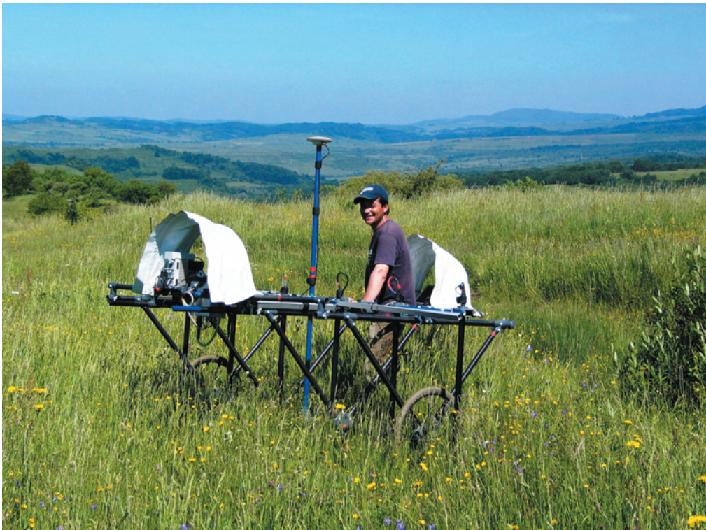
Abb. 2. Das Magnetometer-Array mit 6 Sonden im hohen Gras von Inlaceni, Gesteuert von Ali Ismaeil aus Kiel.
